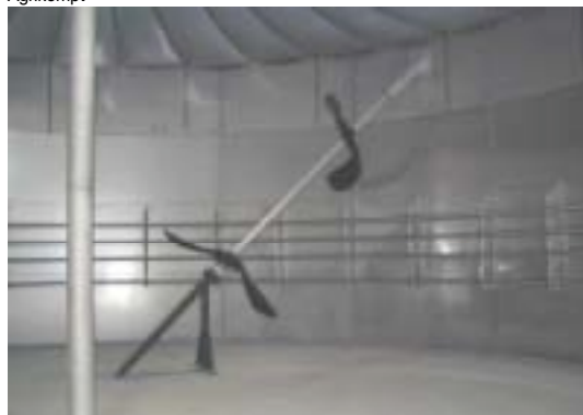
Mélangeur à grandes pales sur axe horizontal. Photo Agrikomp
