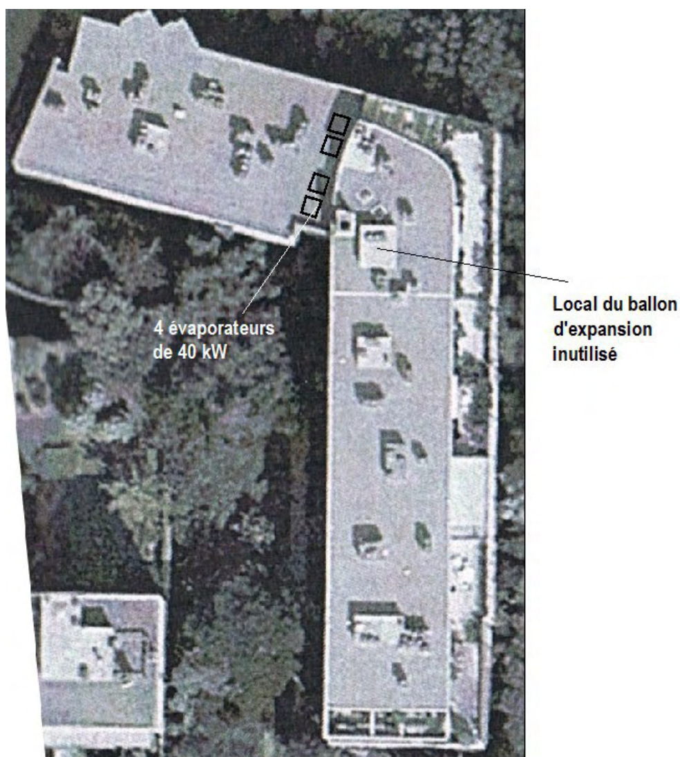
Figure 8 Evaporateurs en toiture
