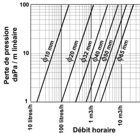
*Chute de pression en ligne avec de l'eau à 50°C et de faibles vitesses de circulation
