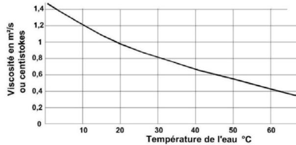
*Le transfert de l'eau chaude dans les tuyauteries est encore facilité par le fait que sa viscosité cinématique diminue lorsque sa température augmente*
