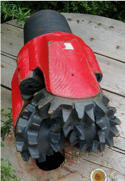
Tête de forage du doublet géothermique
