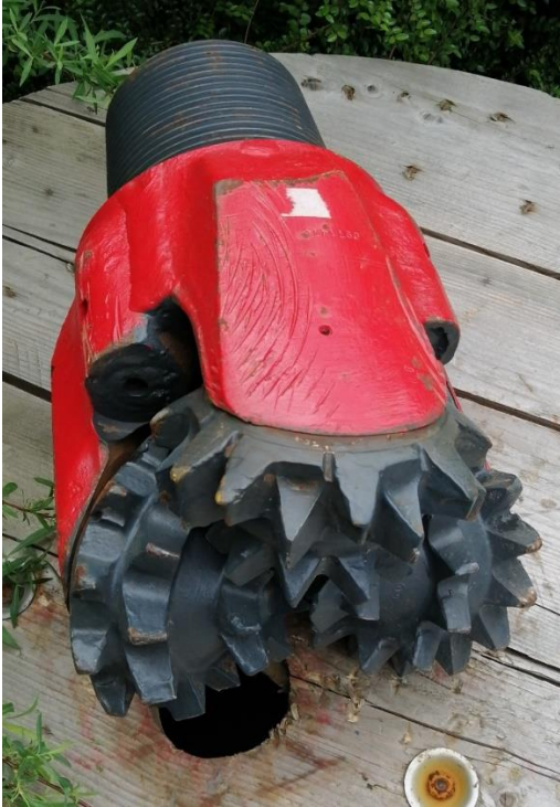
Tête de forage du doublet géothermique
